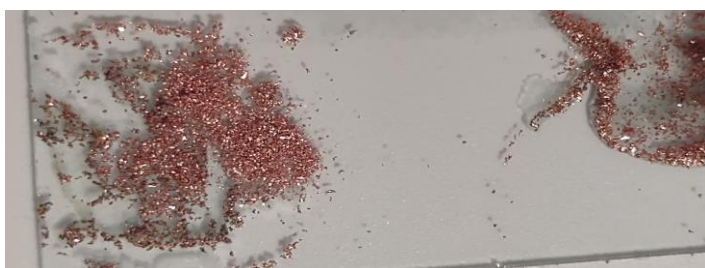
Ilustración 14: Vista proceso de oxidación en cobre
