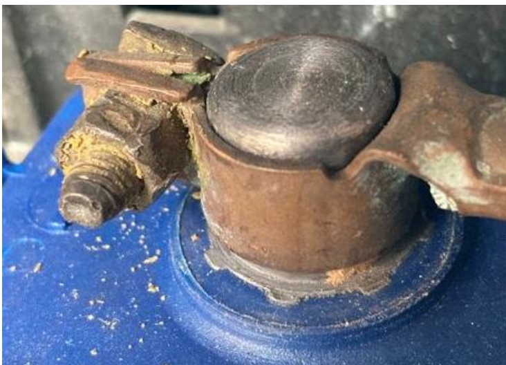
Ilustración 19: Corrosión en bornes de batería
