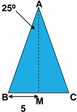
Utilizaremos el triángulo rectángulo ABM y utilizaremos la razón trigonométrica tangente para calcular la altura que es el dato que falta para calcular el área.
