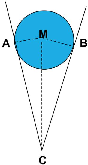
Utilizaremos el triángulo rectángulo  $MCB$  (rectángulo en  $B$ ) y utilizaremos la razón trigonométrica seno para calcular el ángulo.
