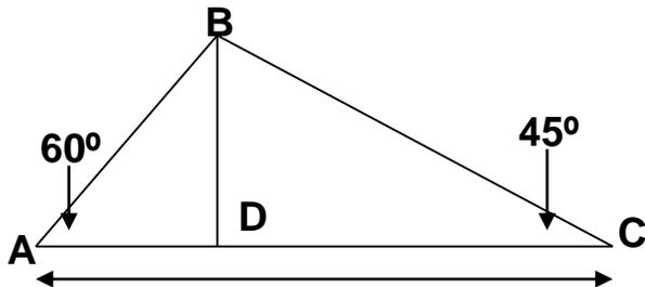
El objetivo es calcular BD, utilizaremos los triángulos rectángulos ABD y BDC, la tangente de  $60^\circ$  y  $45^\circ$  y que el segmento AC mide 126m
