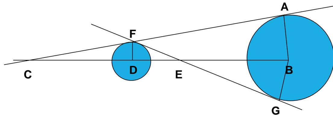
Para calcular el ángulo en C, utilizaremos el triángulo ABC y el triángulo CDF. Además, ambos triángulos son rectángulos y semejantes (tienen 3 ángulos iguales).
