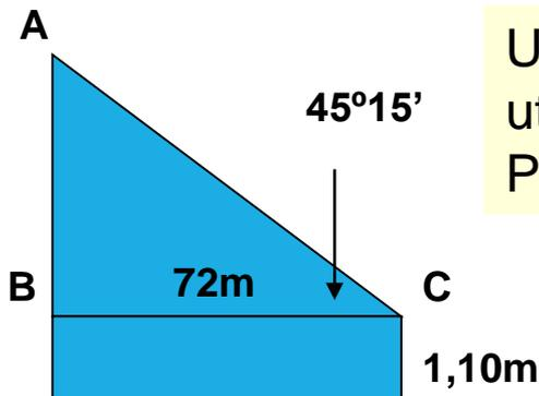
Utilizando el triángulo ABC, que es rectángulo en B, utilizaremos la tangente de C para calcular AB. Posteriormente, sumaremos al resultado parcial 1,10m.
