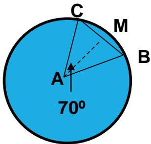
El triángulo ABC es isósceles. Tomaremos el punto medio del segmento CB, que coincide con el punto donde corta la altura del triángulo trazada desde A y es la bisectriz del ángulo A.
