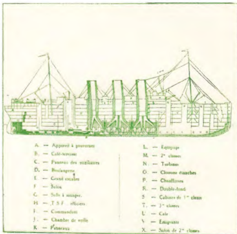
9. Coupe longitudinale d'un transatlantique
