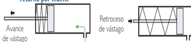
Fig 12: Principio de funcionamiento de un cilindro S/E con retorno por muelle
