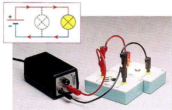
Si une lampe est grillée (ou dévissée), l'autre (*fonctionne/ne fonctionne plus*) car la boucle dans laquelle elle se trouve est (*fermée/ouverte*).
